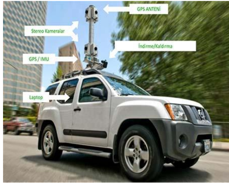
Şekil 1. Mobil haritalama aracı ve parçaları
